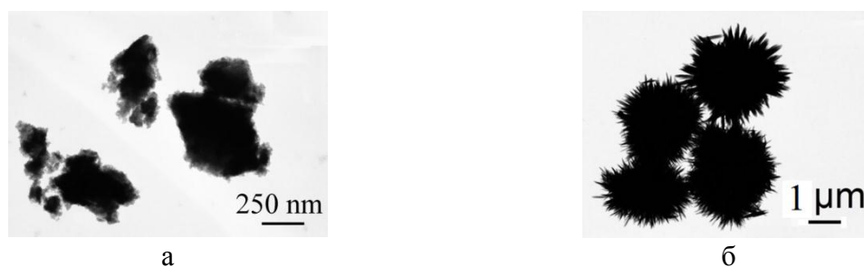
Рис. 1. ПЭМ изображения оксида железа: а - полученного осаждением из раствора соли; б - гидротермальное окисление.
