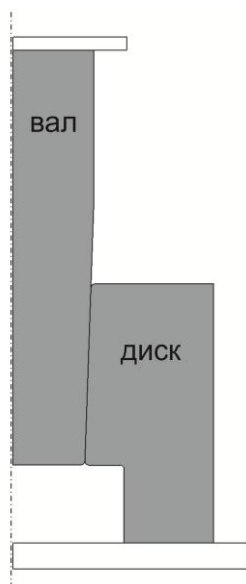
Рис. 1. Конечно-элементная модель детали «диск-вал».
