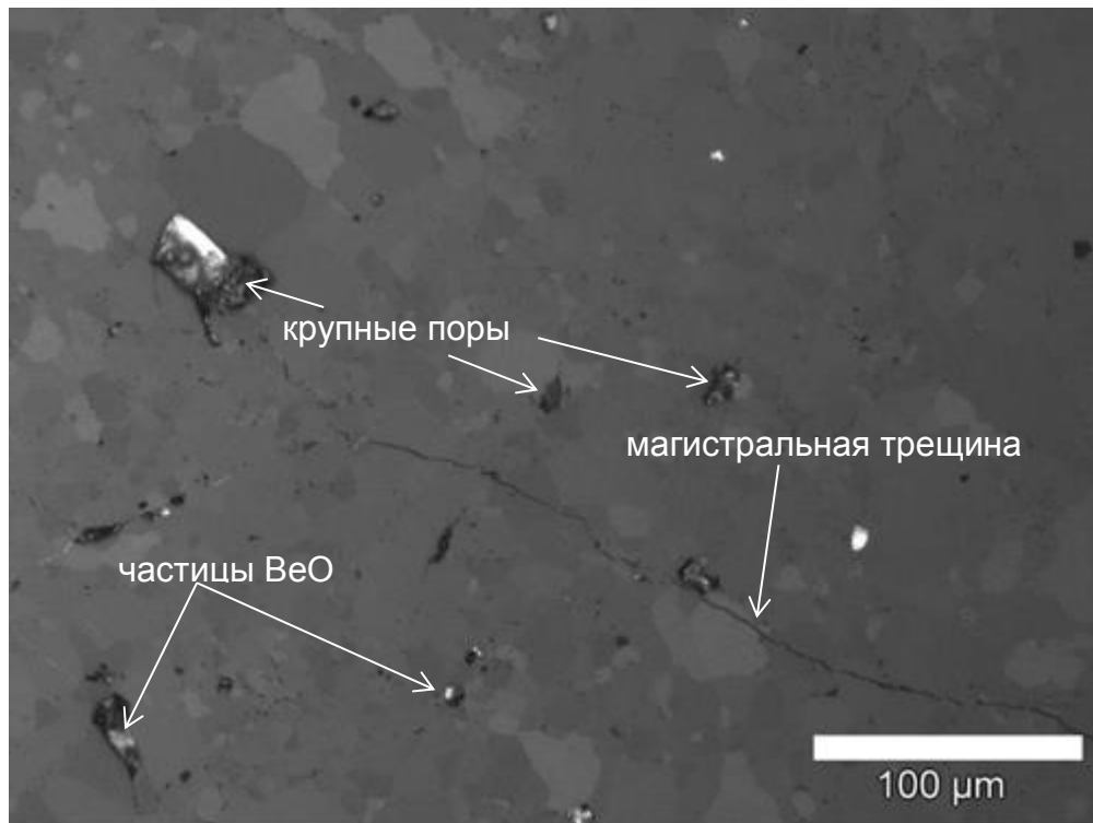
Рисунок 6.6 - Микроструктура облученного бериллия с магистральной трещиной, распространяющаяся как по границам, так и по телу зерен
