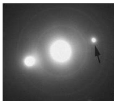
Рисунок 2.3 - Порядок определения типа дислокационной петли в облученном бериллии:
