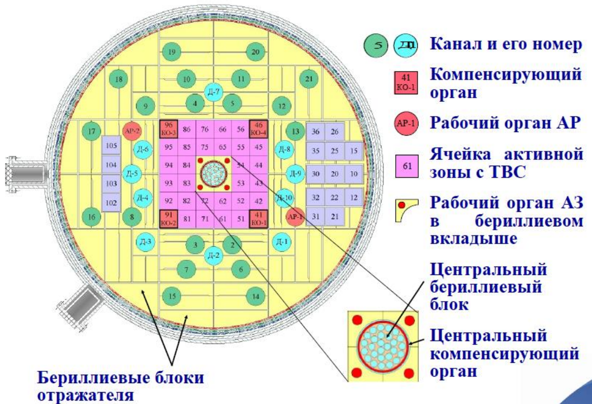
Рисунок 0.2 - Активная зона исследовательского ядерного реактора CM
