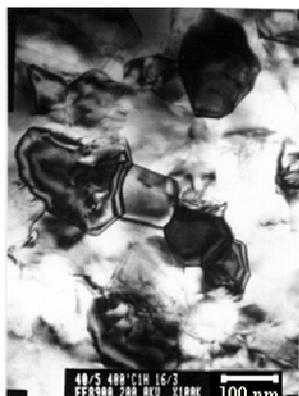
Электронномикроскопическое изображение структуры нанокристаллического Fe
