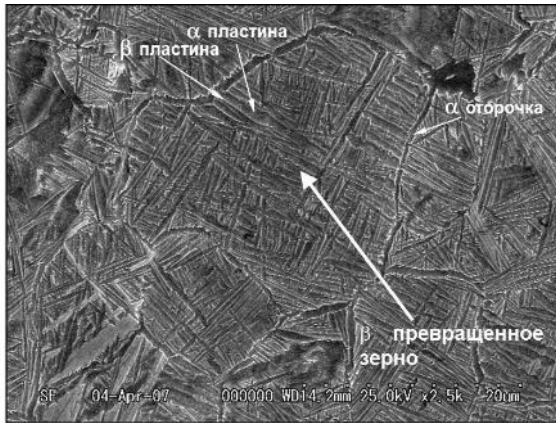
Рисунок. 11.1. Типичная микроструктура в зоне перемешивания СТП-шва в титановом сплаве Ti-6Al-4V.
