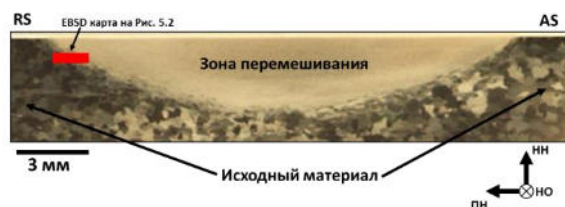
Рисунок 5.1. Поперечное сечение ОТП-зоны в чистом железе
