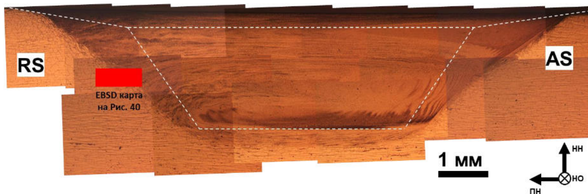
Рисунок 7.1. Поперечное сечение деформационной зоны образовавшейся в ходе ОТП супераустенитной стали S 31254. Пунктирные линии на рисунке обозначают контур сварочного инструмента.
