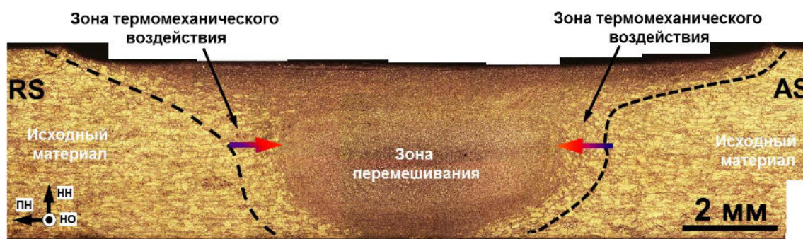
Рисунок 2.3. Иллюстрация метода изучения эволюции микроструктуры посредством анализа зоны термомеханического воздействия: фотография поперечного сечения обработанного материала. Пунктирная линия обозначает примерную границу зоны термомеханического воздействия. Цветные стрелки показывают изменение деформации и температуры; переход от синего цвета к красному соответствует увеличению деформации и/или температуры.
