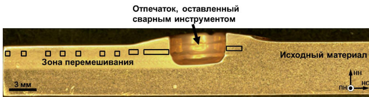
Рисунок 9.6. Оптическая фотография, иллюстрирующая продольное сечение образца после «stop action» эксперимента при температуре обработки 0,61T_m . Прямоугольники соответствуют EBSD картам, приведенным на Рис. 9.7 и 9.8. Подробности приведены в разделе 9.3.
