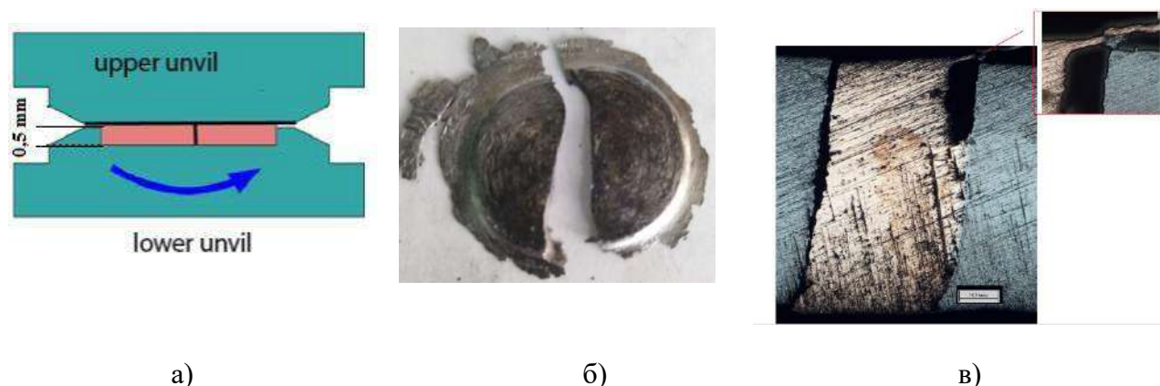
Рис. 1. а) Схема метода «совместного ИПДК двух половин» для оценки проскальзывания; б) Две половины титанового диска после совместного ИПДК n = 1 ; в) Торцы образца Ti со вставкой Cu после предварительного ИПДК ( n=2,5 ) и ИПДК n = 0,15 . Наблюдается незначительный наклон тела медной вставки (проскальзывание в толще материала >90\% , и течение полосы меди толщиной 10 мкм по поверхности Ti, выделено красным)
