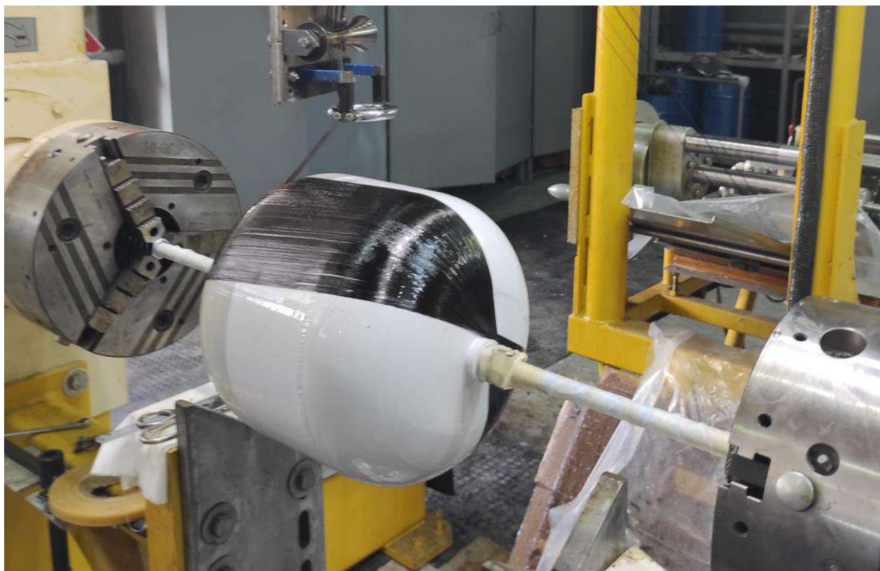
Рис. 1. Намотка с натяжением пропитанного связующим углеродного жгута на тонкостенный полимерный лейнер
