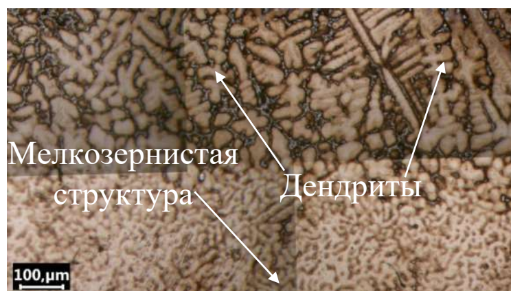
Рис. 2. Исходная структура ВЖМ7 (а); микроструктура ФГМ (б)
