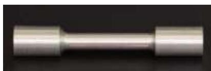
Рис. 1. Образец с нанесенной риской
