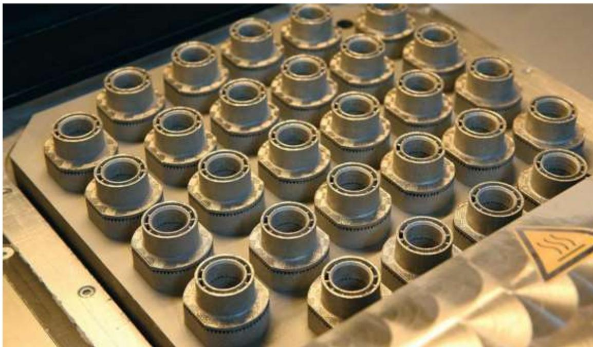
Рис. 1. Завихрители фронтального устройства камеры сгорания двигателя ПД-14 [1]
