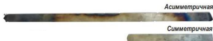
Рис. 1. Образцы после асимметричной и симметричной прокатки за один проход
