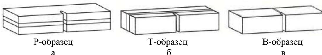
Рис. 1. Вид образцов для испытаний на ударный изгиб
