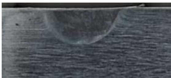
Рисунок 1 – Макроструктура биметаллического соединения из алюминиевых сплавов АК4-1 и АК12, изготовленного в процессе трения с перемешиванием
