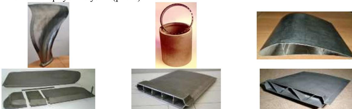
Рис. 1. Изделия, полученные по технологии СПФ/ДС в ИПСМ РАН
