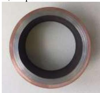
Рис 1. Внешний вид слоя напыленной бронзы БрХ08
