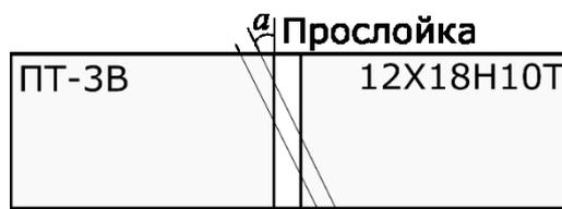
Рисунок 2.3 – Схема подготовки косых шлифов
