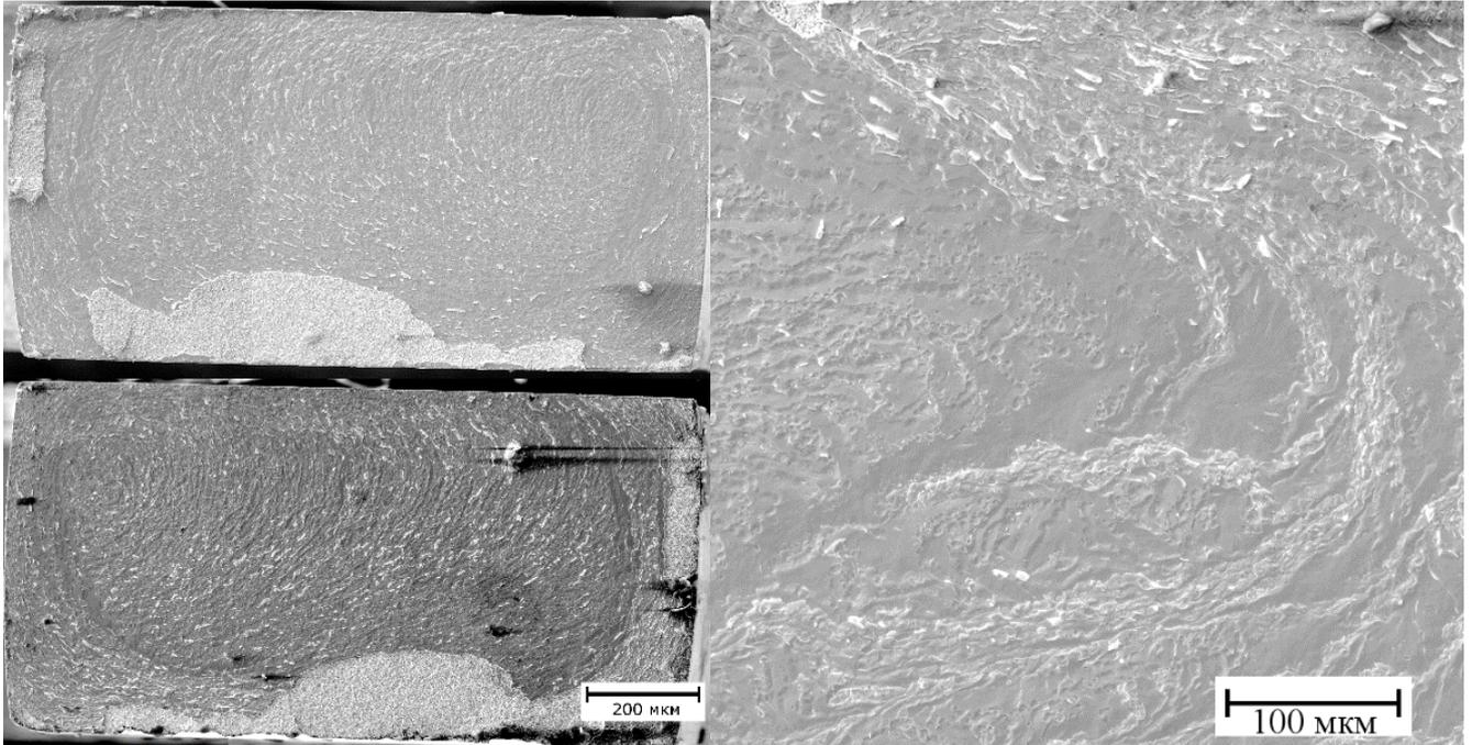
Рисунок 4.4 – Излом образца после сварки давлением через КЗ никель при 800 °С
