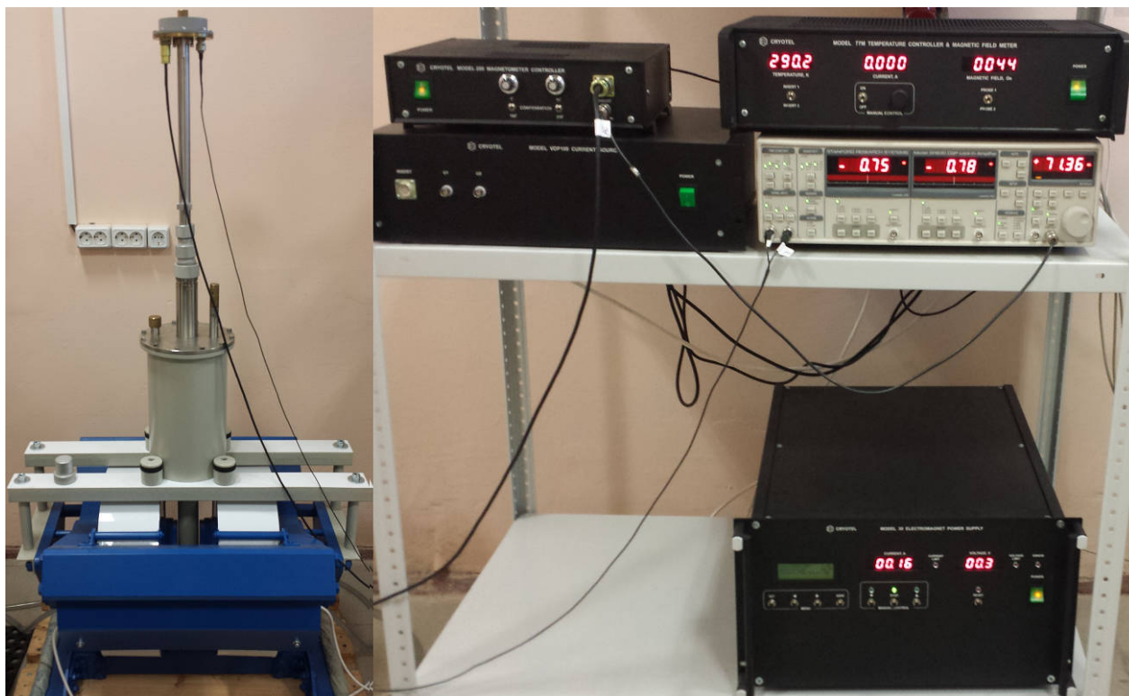
Рисунок 2.7 — Внешний вид магнитометра АЛКГМ-1: измерительная система с криостатом и электромагнитом (слева) и электронная система сбора данных и управления электромагнитом (справа).
